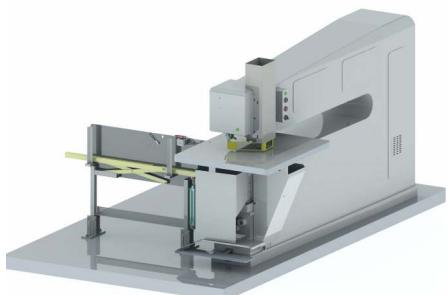
Станок очень прост в использовании и не требует высококвалифицированного персонала. Вырезание дефектных участков и установка заплаток происходит за один цикл движения штампа. Оператору нужно только подвести дефектный участок под штамп и нажать на педаль.
